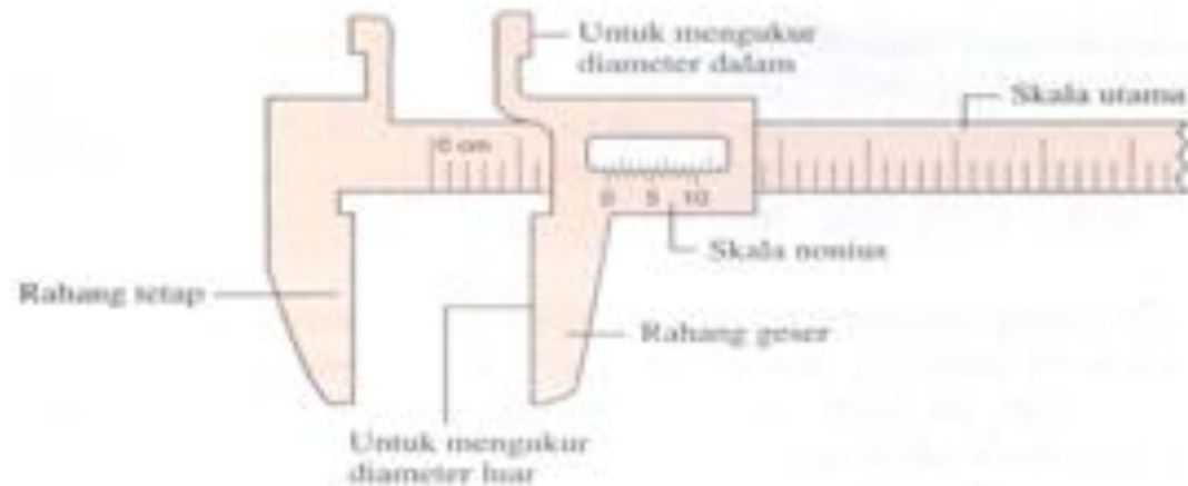
Gambar 1.2 Jangka sorong dan bagian-bagiannya
